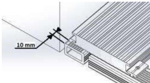
Při pokládce okrajových prken je potřeba (po celém obvodu terasy) ponechat vůli min. 10 mm. Tato vůle slouží pro vymezení délkové roztažnosti desek vlivem změn okolní teploty a vlhkosti.
