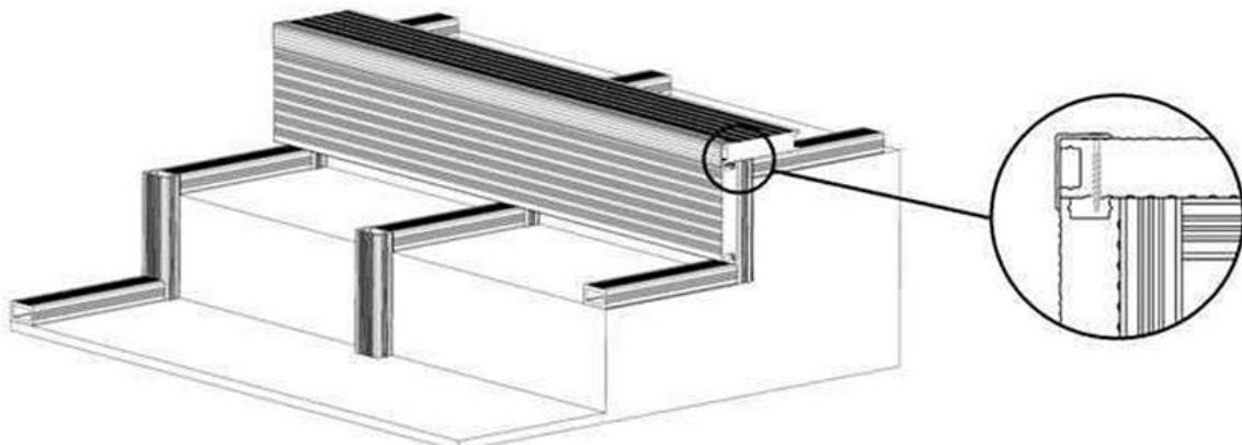
Pro překrytí spoje, na sebe kolmých terasových prken je vhodné použít hliníkovou schodovou lištu. Ta se připevňuje shora pomocí vrutů. Aby vruty z lišty nevyčnívaly, je nutné otvory zahloubit dle potřeby šroubu. Rozteč mezi vruty by neměly přesáhnout 200 mm.
