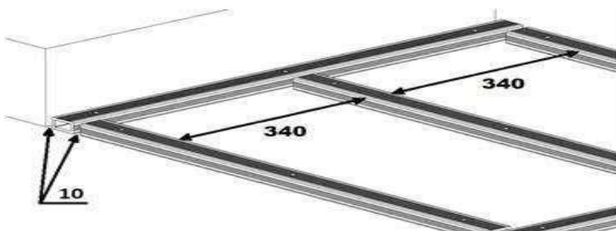
Horní otvor v konstrukčním hranolu vrtáme vrtákem  **$\phi 8\text{ mm}$** , což nám umožní prostrčení šroubů a jejich utažení. Hranoly upevňujeme k podloží pomocí hmoždinek min.  **$\phi 6\text{ mm}$** , doporučená délka hmoždinek je alespoň **40 mm**.
