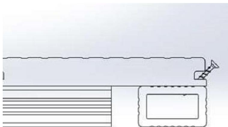
Pro ukončení systému můžeme použít krycí lištu. Řežeme ji pod úhlem 45°. Montáž krycí lišty na nekryté hrany systému provedeme přišroubováním samořeznými vruty do konstrukčních hranolů.
