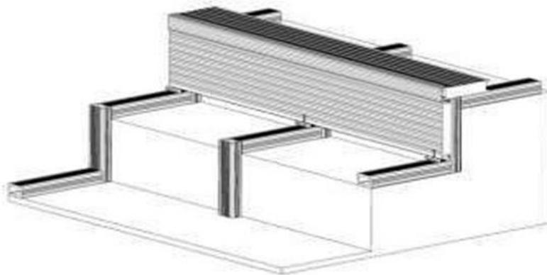
Položení terasového prkna na nášlapnou plochu schodu začneme přišroubováním jednoduchých klipů do konstrukčních hranolů. Do nich potom zapasujeme terasové prkno.
