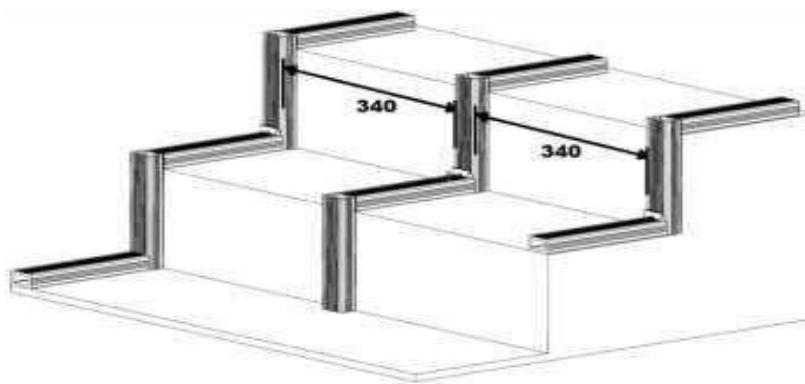
Pokládku začínáme přišroubováním jednostranných klipů na hranoly pomocí vrutů. Do připevněných klipů zapasujeme terasové prkno, horní stranu přišroubujeme pod úhlem vruty. Před samotným šroubováním je potřeba předvrtat otvor o průměru 3 mm.
