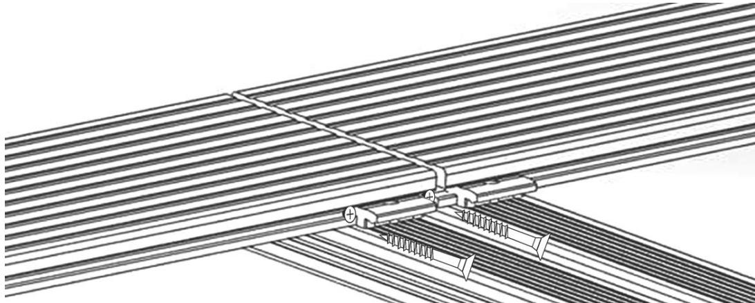
Montáž posledního prkna se provádí s použitím jednoduchého klipu nebo přišroubováním prkna pod úhlem přímo ke konstrukčnímu hranolu.
