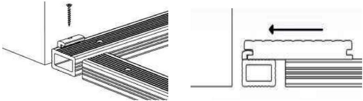
Pokládku začínáme přišroubováním jednoduchých klipů na okraj nosné konstrukce samořeznými vruty. Do nich poté **naklepeme** první řadu terasových prken (naklepávání provádíme přes hranol z měkkého dřeva přiměřenou silou, ideálně gumovou palicí). To platí, začínáme-li pokládku od zdi nebo jiné svislé překážky. V případě pokládky z otevřeného prostoru se pokládka začíná i ukončuje stejným způsobem – viz níže „montáž posledního prkna“.
