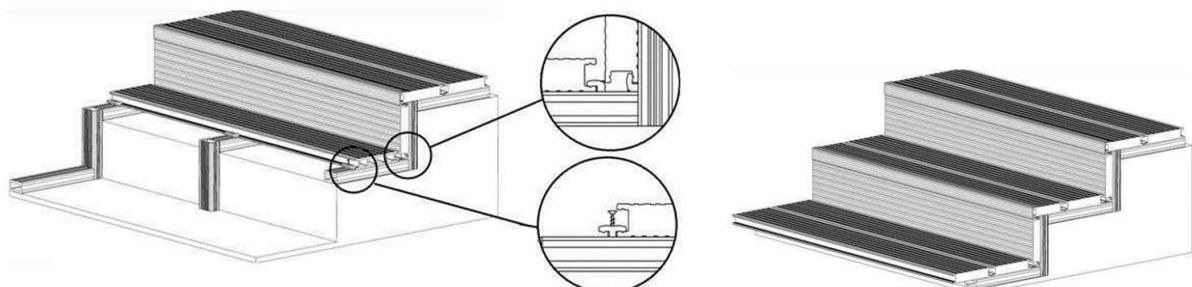
Zapasované prkno upevníme dvojitými klipy, které slouží rovněž pro uchycení dalšího prkna. Při pokládce dalších schodů postupujeme dle výše uvedených instrukcí.
